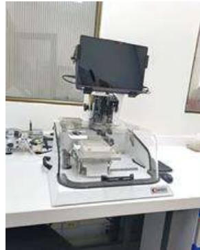
Ilustración 3 Equipo perforador semiautomático para tarjetas FTA Genética - Regional Bogotá.
