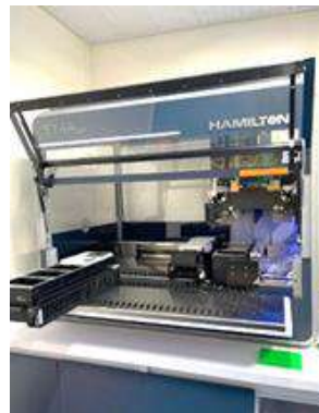
Ilustración 2 Equipo de pipeteo multicanal, automatizado de aplicación forense Genética - Regional Oriente. Fuente: GNCIF, Subdirección de Servicios Forenses
