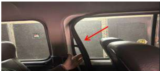
Imagen 30. Imagen obtenida durante visita de inspección: cauchos sueltos al interior de la OBH434
